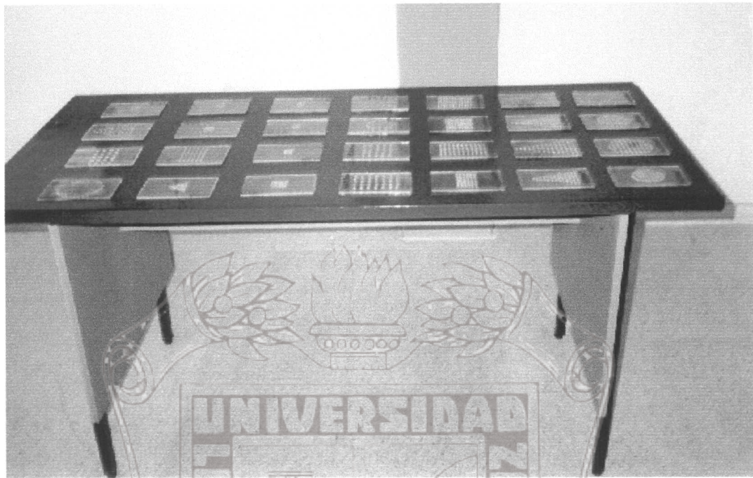
Figura 8.7 Fotografía de las coladeras pluviales de orificios circulares utilizadas en el prototipo.
