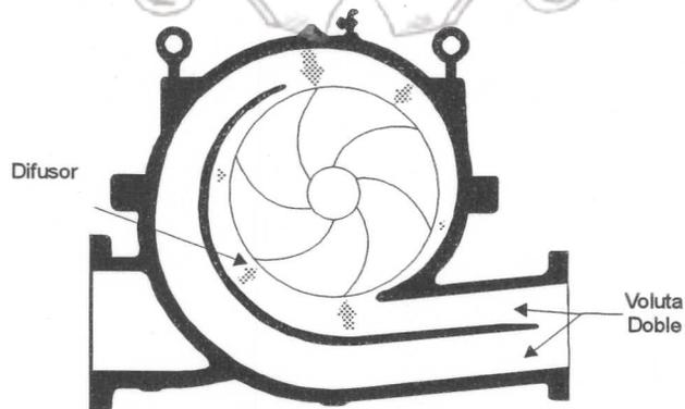
Figura 1.9 Carcazas de voluta doble son usadas en bombas centrífugas grandes para reducir las cargas radiales
