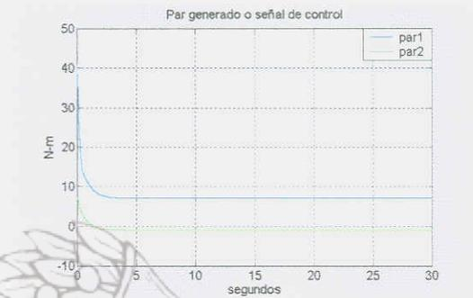
**Figura 5.39.** Torque generado por el control de modo DESLIZANTE.
