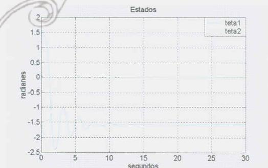
**Figura 5.3.** Simulación en lazo abierto con condiciones iniciales  $\theta_1 = \pi/2$  y  $\theta_2 = -\pi/2$ .
