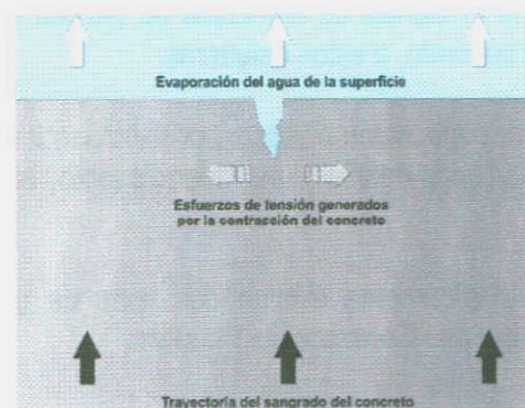
Figura 4.4 Grieta por contracción plástica.
