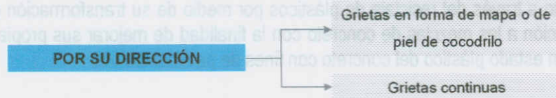
Figura 4.6 Clasificación de las grietas por su dirección.
