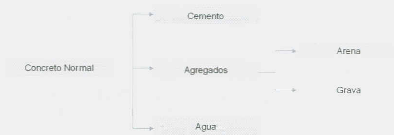
Figura 8.2. Elementos que componen un concreto normal.
