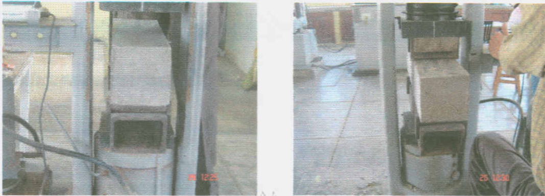
a. Colocación de la viga
